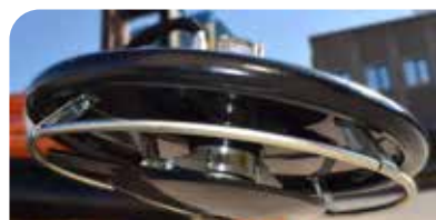
Disco desbrozador con dos cuchillas
