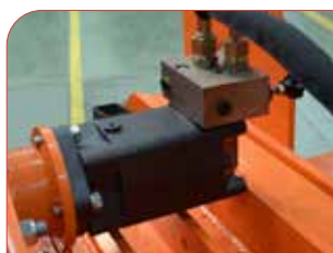
Motor hidráulico regulable del rodillo alimentador.
