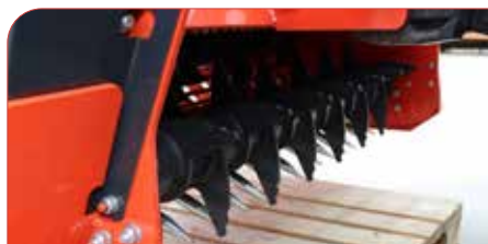
Púas y rodillo alimentador independiente y regulable.
