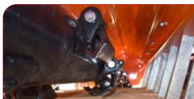
Martillos sobre eje de 168 mm.
