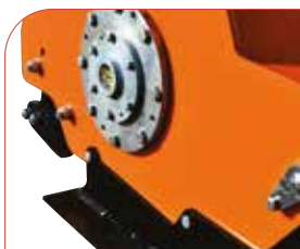
Refuerzo lateral del rotor. Ajuste de rodillo y patín.
