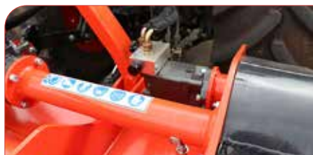
Motor hidráulico regulable.
