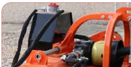
Sistema hidráulico: depósito + doble bomba
