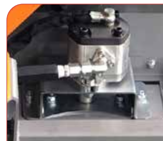
Motor hidráulico y transmisión con correas
