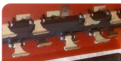
Martillos y eje de 170 mm.
