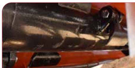
Martillos sobre eje de 168 mm.
